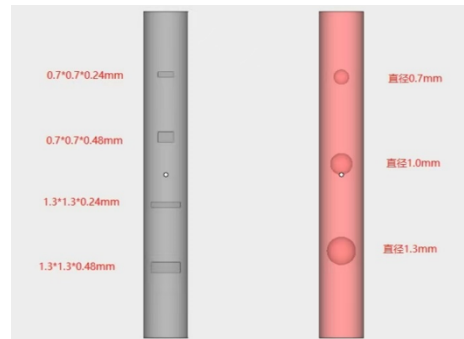
图1 预设缺陷试块方案示意
